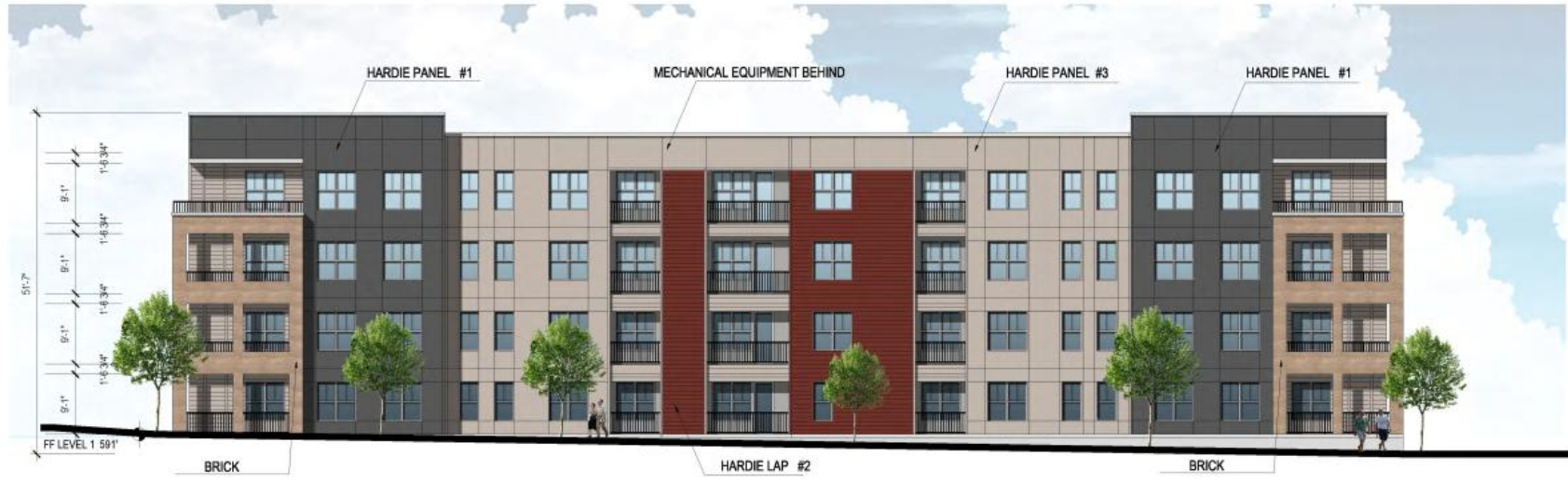
BLDG 2 RIGHT ELEVATION
